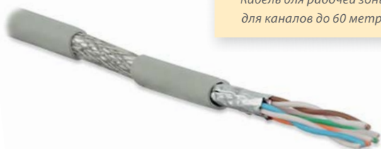
Внешняя оболочка Экран-оплетка Дренажный провод Экран-фольга Витая пара solid
